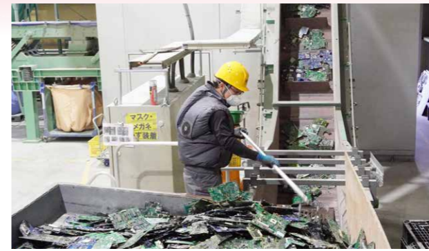
廃基板を破碎機に投入
