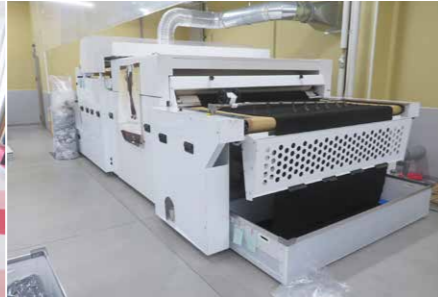
生地を加熱しあらかじめ縮める縮絨機。2台を新規導入した
